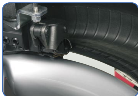
➤ Procedimiento estándar de desmontaje del talón inferior con torreta Procedimento padrão de desmontagem do talão inferior com torre
