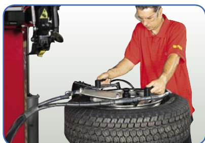
» Kit entalonadura rápida: TI System Kit de colagem rápida: TI system
