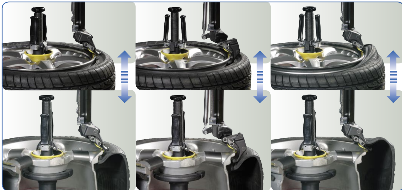
➤ Procedimiento de desmontaje del talón superior. Procedimento de desmontagem do talão superior
