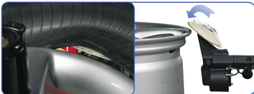
➤ Procedimiento rápido de desmontaje del talón inferior mediante disco destalonador (especialmente indicado para lados duros) Procedimento rápido com disco descolador (indicado principalmente para flancos duros) para a desmontagem do talão inferior
