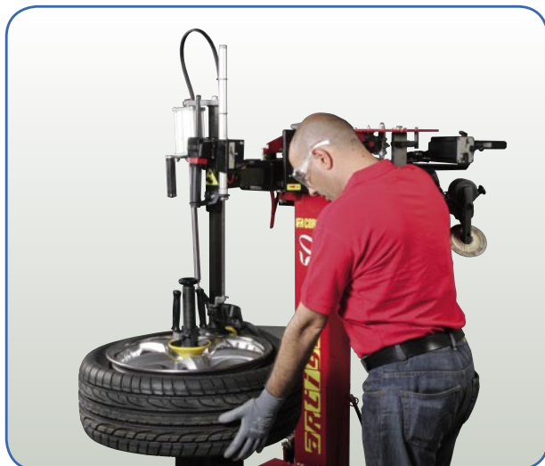
➤ Procedimiento de desmontaje del talón superior. Procedimento de desmontagem do talão superior
